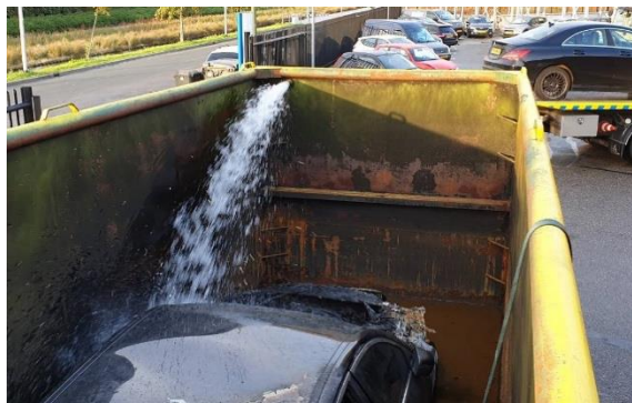
Figuur: dompelcontainer voor koelen elektrische auto
