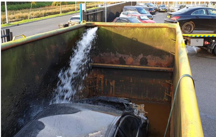
Figuur: dompelcontainer voor koelen elektrische auto
